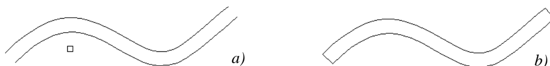
Sl. 4.14 Rezultat ofsetiranja i naknadnog spajanja krajeva splajnova linijskim entitetima komandom Line i kriterijumom vezivanja Endpoint
