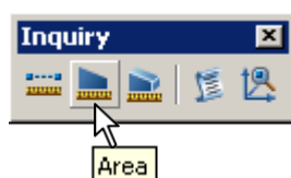
Sl. 2.67 Paleta alata Inquiry za utvrđivanje nekih geometrijskih svojstava objekta
