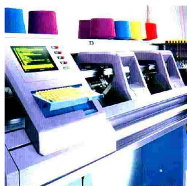
Слика 10.64: Уређај за управљање, програмирање и надгледање петења
