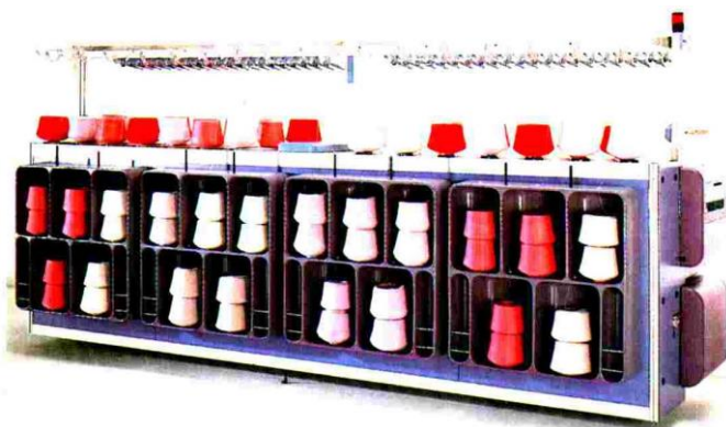
Слика 10.41: Магацин за смештај калемова на машини
