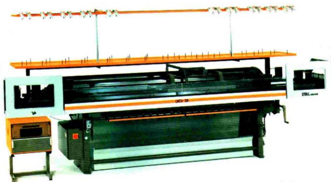
Слика 10.32: Општи изглед лево-левог аутомата тина LNCU-2B selectanit
