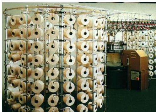
Слика 6.13: Положај калемова и основиних ваљака на машинама за плетење
