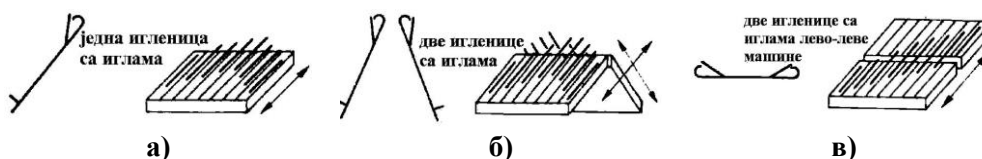
Слика 10.2: Шематски приказ игленица равних машина за плетење
