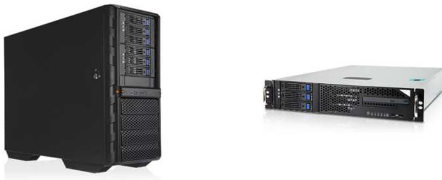
Slika 16. Tower i rackmount serveri [100]
