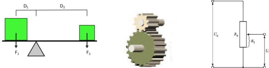
Slika 3.2. Neki primeri proporcionalnih elemenata: a) poluga, b) zupčasti prenosnik, c) potenciometar
