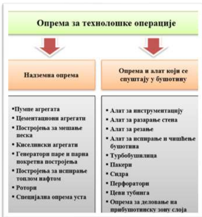
Слика 3.1 – Класификација опреме за текући и капитални ремонт бушотина
