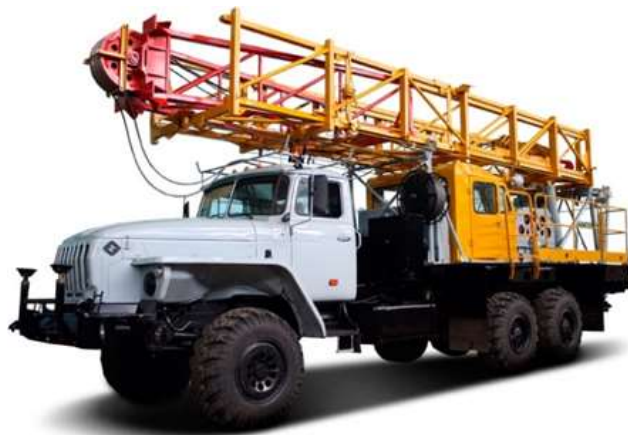
Слика 3.8 – Дизалица АПРС-40 за текући ремонт бушотина (Русија)
