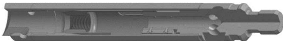
Слика 3.26 – Хватаљка типа ЛКШ
