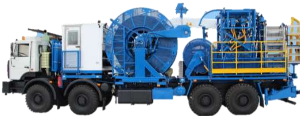
Слика 3.18 – Постројење са савитљивим тубинг цевима МК20Т, СЗАО "ФИДМАШ" (Белорусија)
