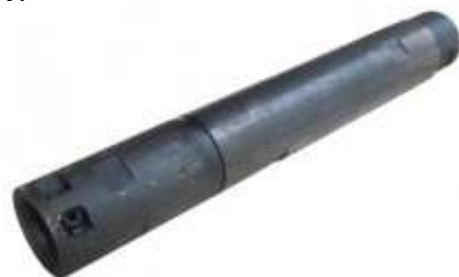
Слика 5.11 – Кашика за цементацију
