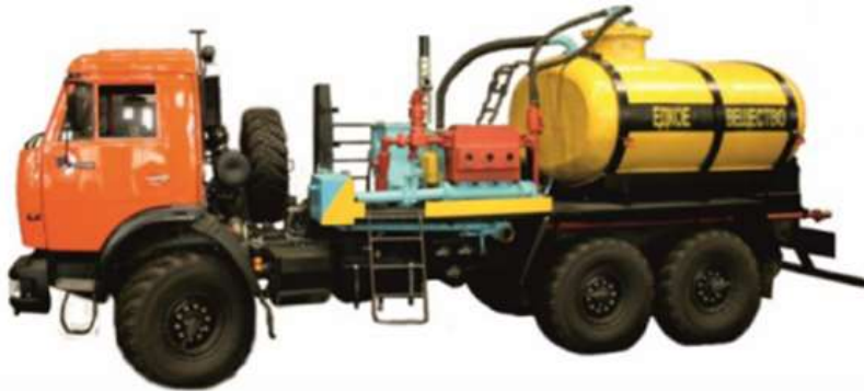
Слика 3.14 – Киселински агрегат УНЦ1-160×500К (Русија)
