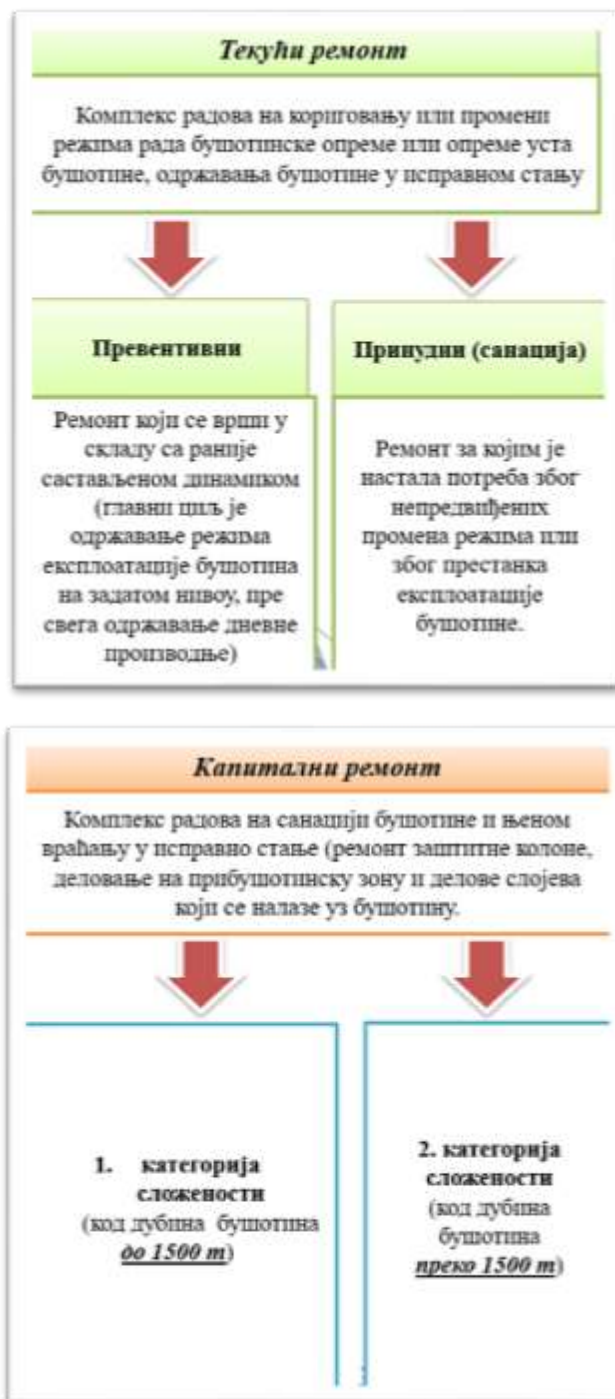
Слика 2.24 – Приказ класификације подземног ремонта бушотина
