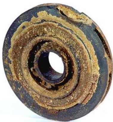
Слика 4.7 – Насlage соли на радном колу електричне центрифугалне пумпе
