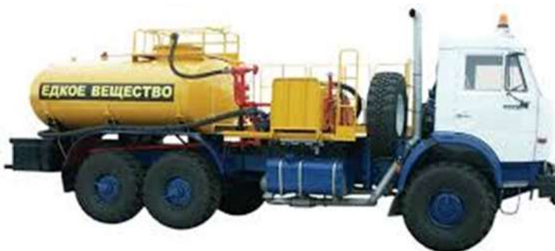
Слика 3.15 – Киселински агрегат СИН-32 (Русија)
