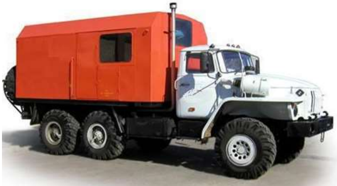
Слика 3.16 – Парно постројење за рад на нафтним пољима ППУА-1600/100 (Русија)
