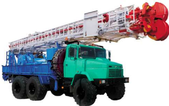
Слика 3.9 – Дизалица А-80М за капитални ремонт бушотина (Русија)
