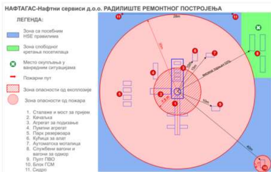
Шема размештаја опреме ремонтног постројења
