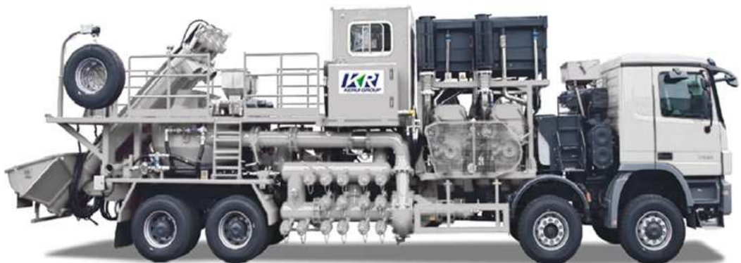
Слика 3.13 – Постројење за мешање песка KHS-20 (USA)
