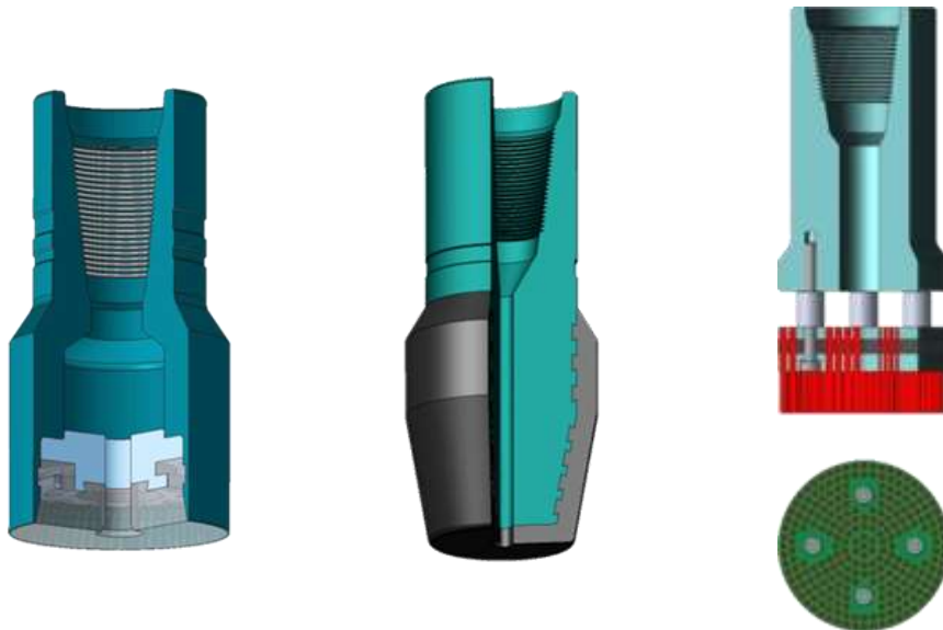
Слика 3.30 – равни печат, бочни печат, 3D печат
